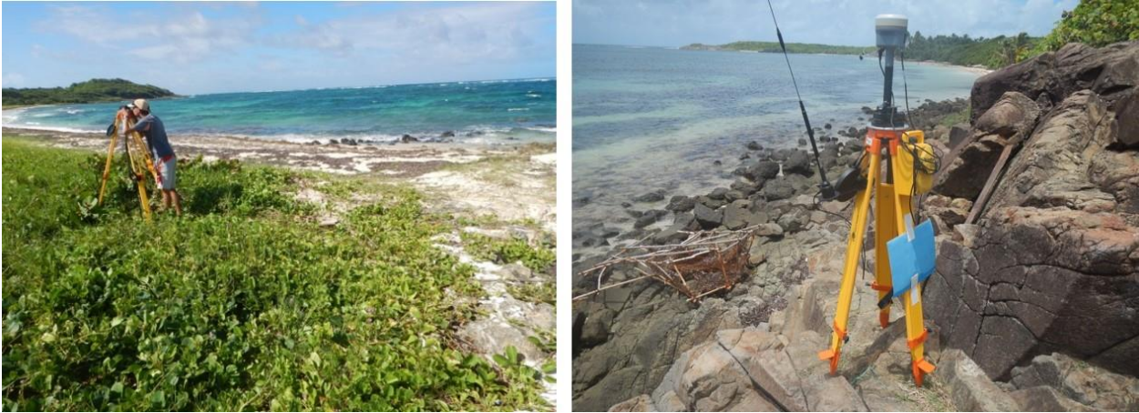
Illustration 5 : Présentation du DGPS © Trimble déployé sur chacune des plages et plus précisément de le récepteur de base fixe à installer avant de parcourir la plage avec le récepteur mobile
