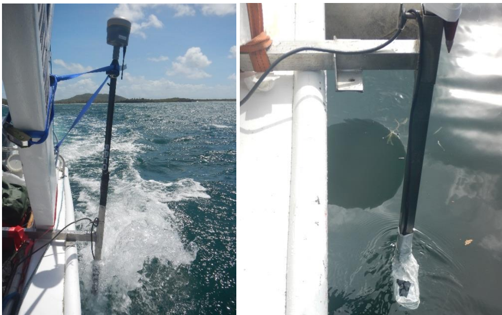
Illustration 6 : Dispositif mis en place par le BRGM dans le cadre de cette étude, pour mesurer la bathymétrie le long des profils de plage : antenne DGPS couplée à un échosondeur (immergé) fixée sur un bateau
