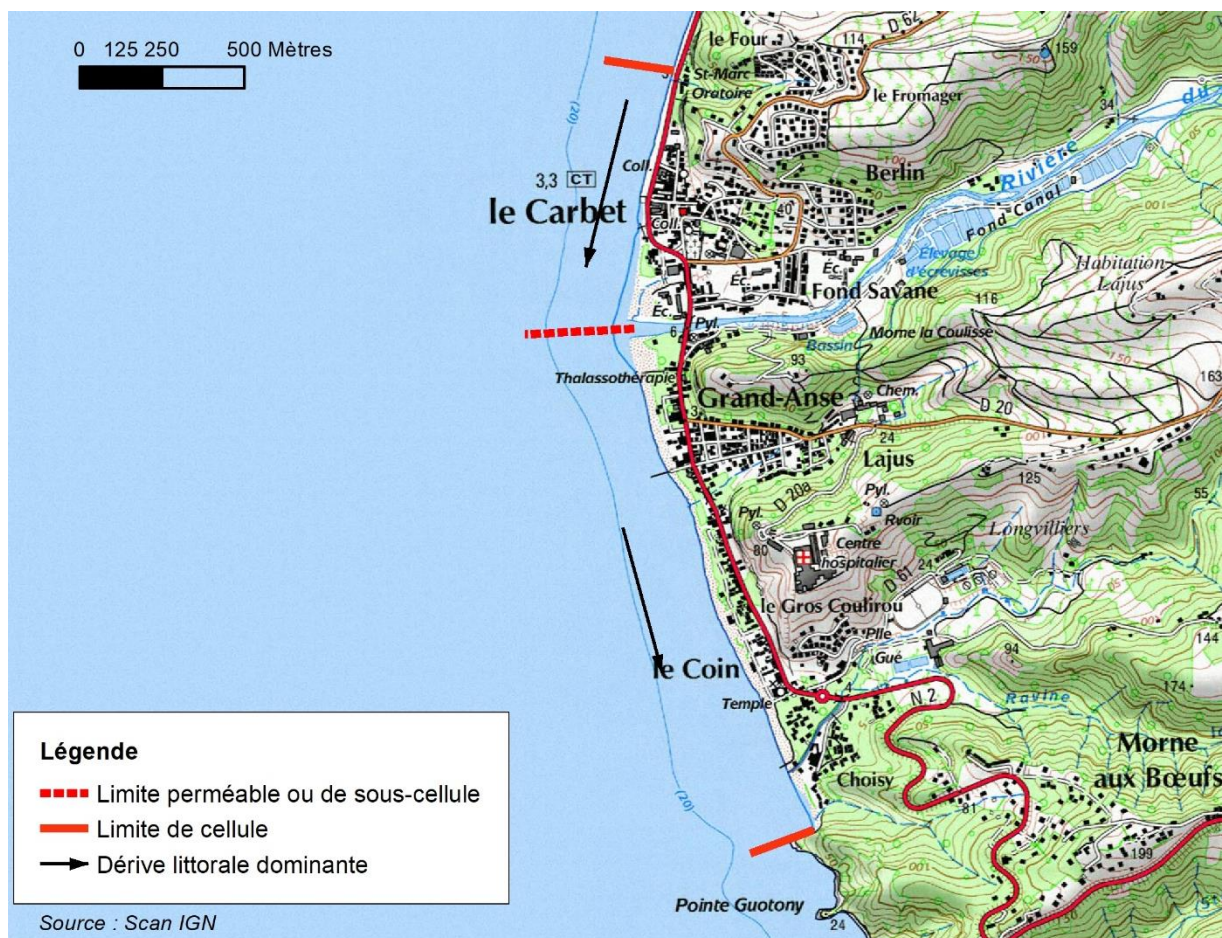
Illustration 16 : Cellule et fonctionnement hydro-sédimentaire de la plage du Carbet (extrait rapport RP-64499-FR)
