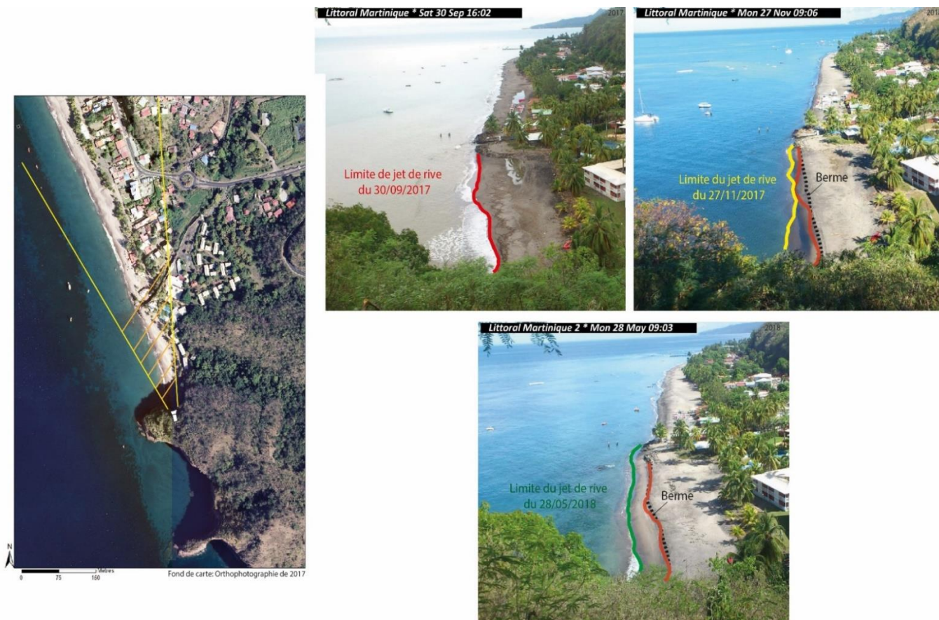
Illustration 26 : Position et suivi par imagerie vidéo de l'évolution du sud de la plage du Coin au Carbet, on observe l'avancée de la position de la limite de jet de rive avec la formation de la berme de plage indicateur d'accrétion.
