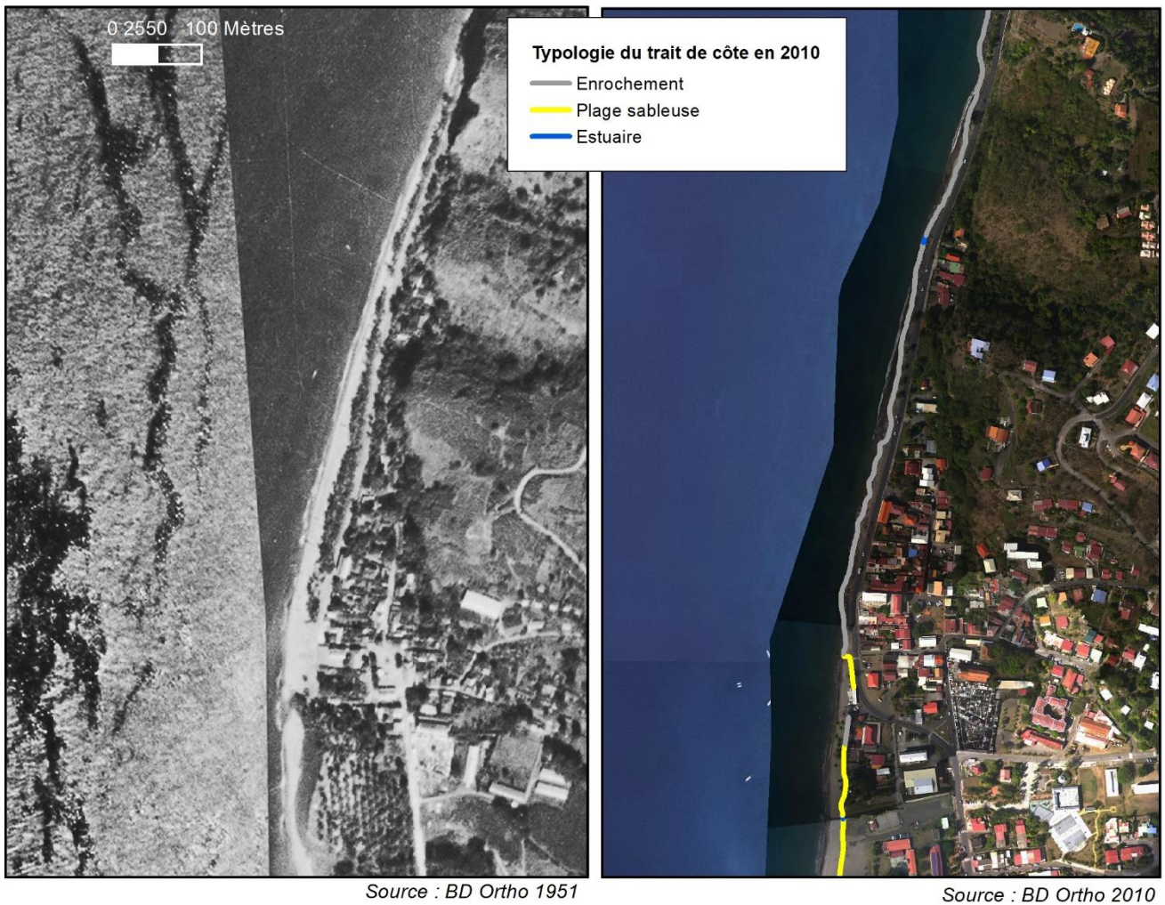
Illustration 21 : Disparition de la plage au droit de l'enrochement
