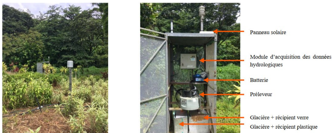
Figure 3 Station météorologique (photo de gauche) et station de suivi des pesticides agricoles (photo de droite)
