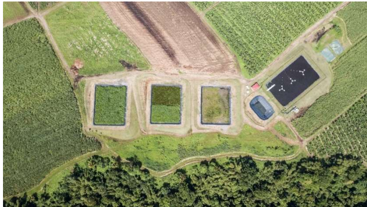
FIGURE 13 : PLAN AERIEN DES FILTRES PLANTES DE VEGETAUX A LA DISTILLERIE JM
