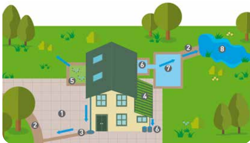
1. Pavement perméable 2. Noue 3. Rigole 4. Toiture végétalisée 5. Réservoir paysager 6. Cuve à eau 7. Bassin 8. Mare
