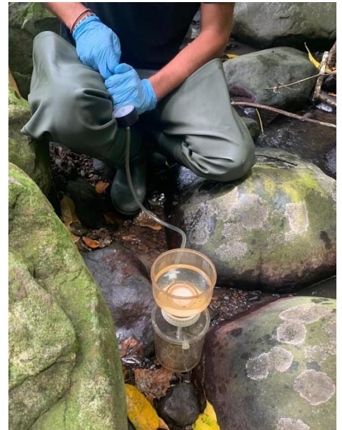
Figure 2. Unité de filtration Nalgene™ connectée à la pompe à vide, afin de filtrer l'eau pour l'étude ADNe
