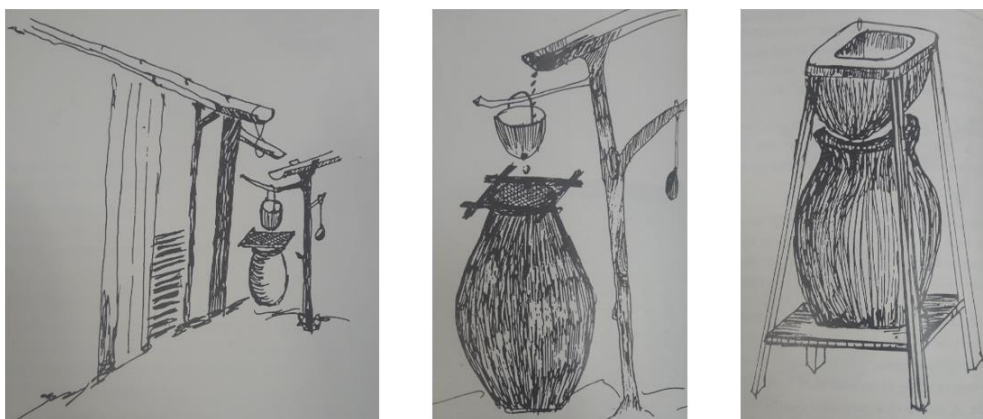
Figure 16 : Croquis de filtre avec pierre à eau (L-F Ozier Lafontaine, 1991)
