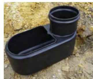
Figure 101 : exemple de tranquillisateur : en cas de mauvaise pré-filtration en amont, des dépôts solides peuvent s'amonceler dans le bac et contraindre l'arrivée d'eau.
