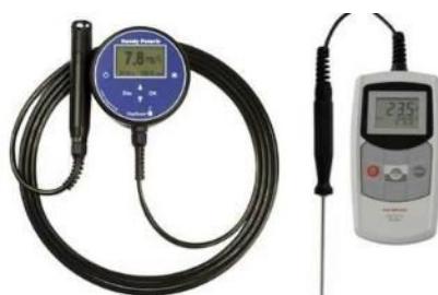
Figure 11 : Sonde multi-paramètres oxymètre OxyGuard, à gauche (source : www.aquamerik.com ) et thermomètre Greisinger (à droite) (source : www.conrad.fr )
