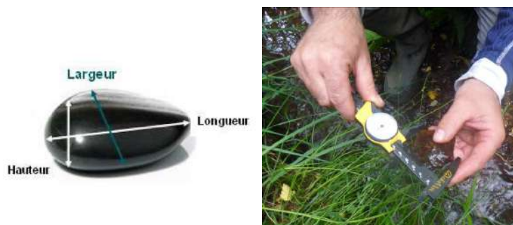
Figure 21 : Mesure de la largeur d'un caillou au pied à coulisse en suivant le protocole Wolman (Source : Protocole CARHYCE, AFB 2017 et FISH-PASS 2017)
