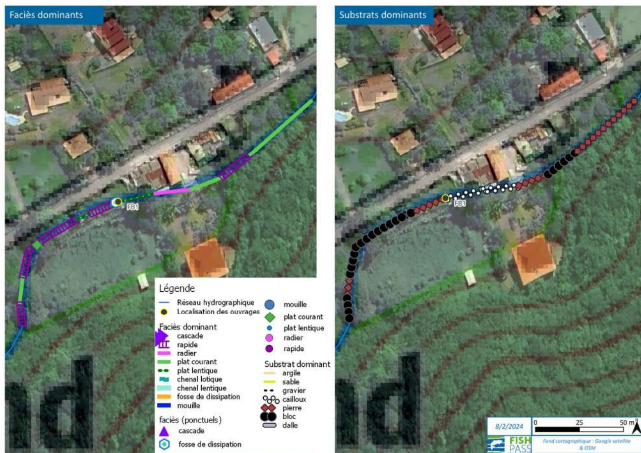
Figure 27 : Cartographie des faciès et substrats dominants sur Fond Bourlet – FB1 (Fish-Pass)
