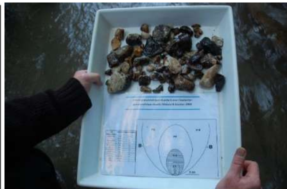
Figure 20 : Echelle granulométrique de Wentworth (1922) et détermination de la granulométrie principale et secondaire (FISH PASS)
