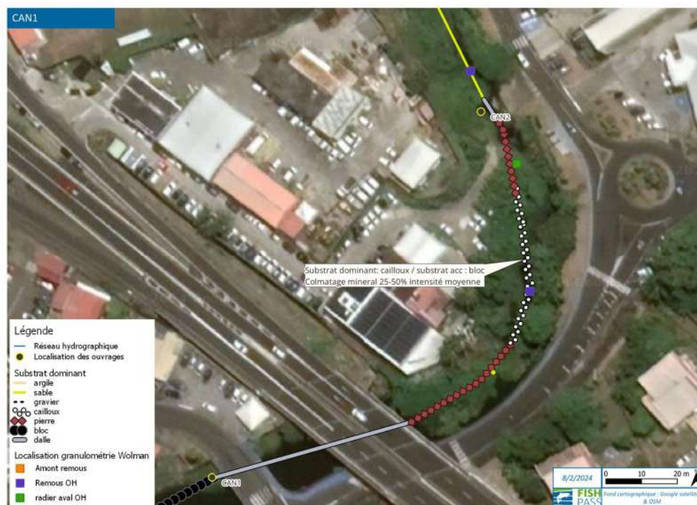
Figure 58 : Localisation des relevés granulométriques de type Wolman sur CN1 (Fish-Pass)
