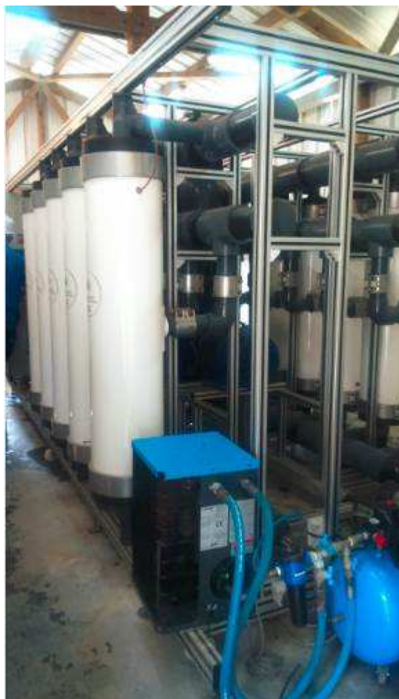
Modules d'ultra-filtration d'Urion
