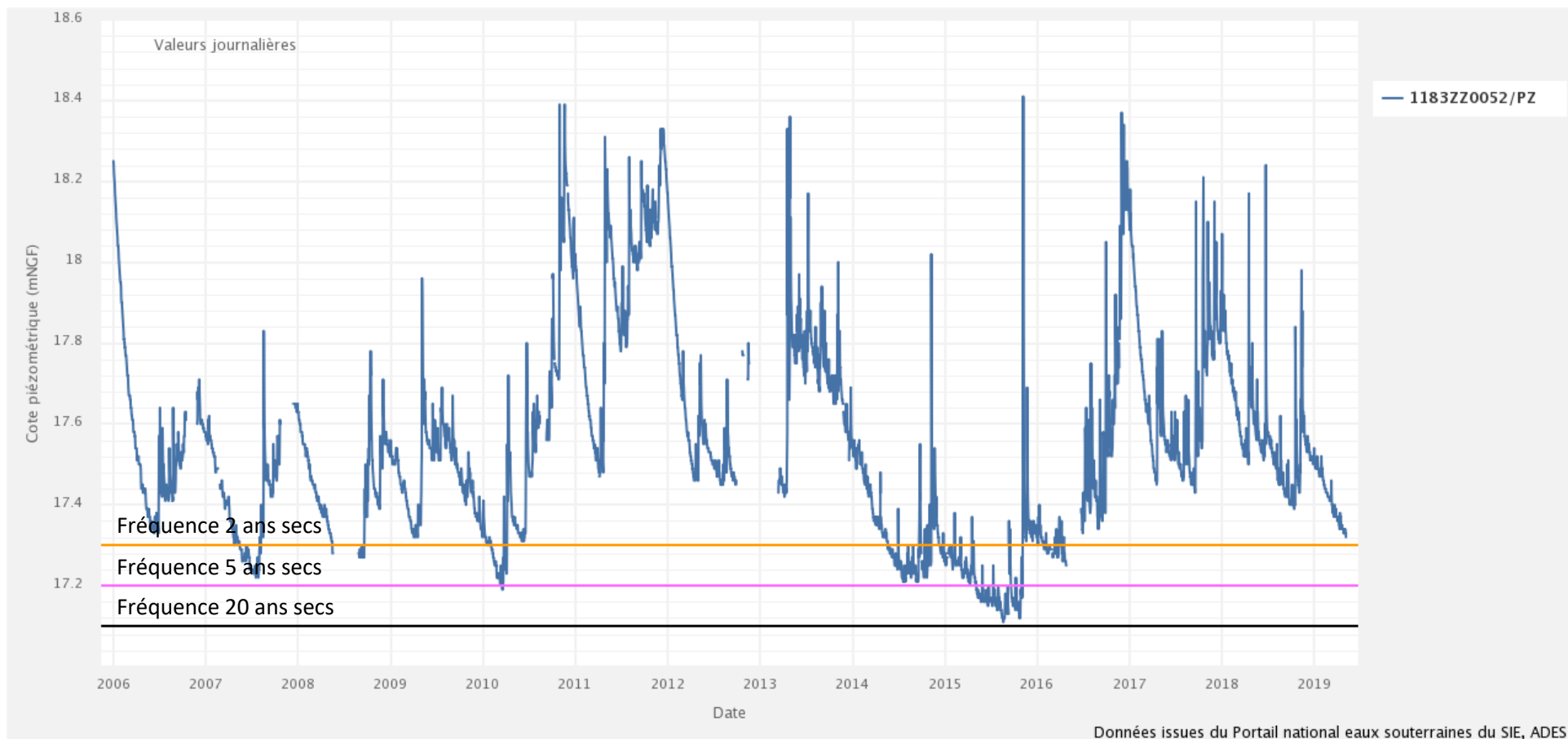
Illustration 57: Chroniques piézométriques du forage 1183ZZ0052 – Fougainville – Rivière Pilote depuis 2006
