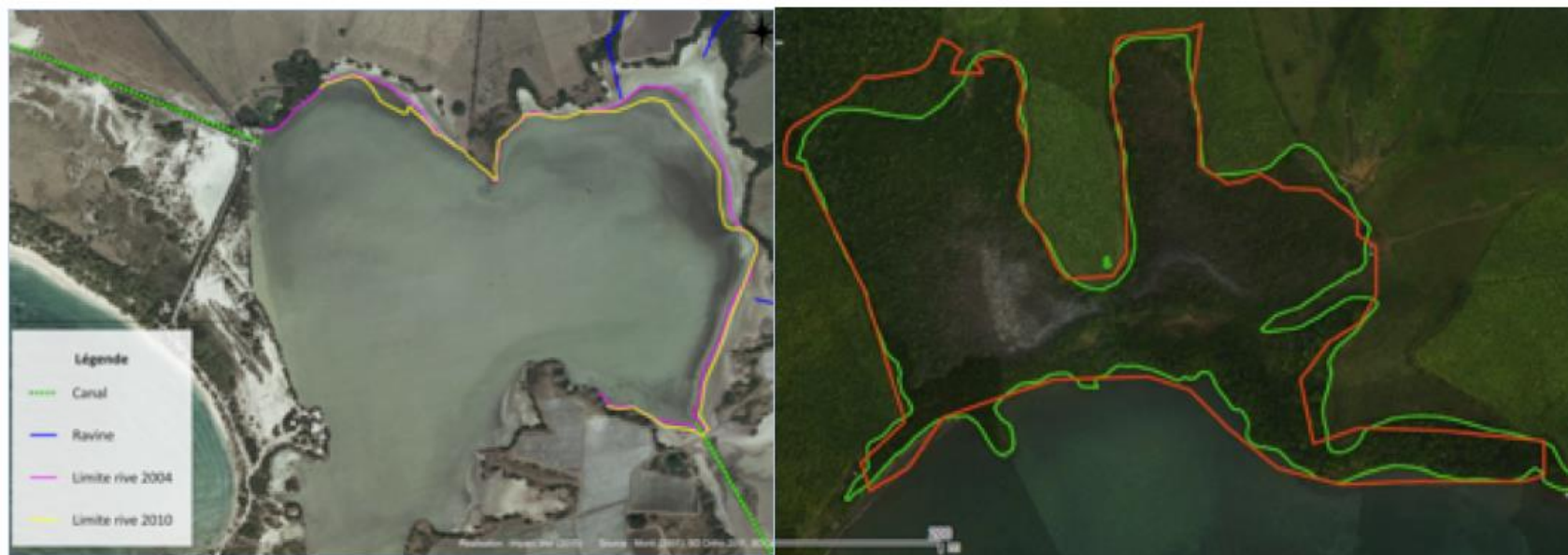
Figure 3 : Gauche : évolution 2004-2010 des rives d'un étang littoral. Droite : évolution 2000-2010 des contours d'une mangrove.
