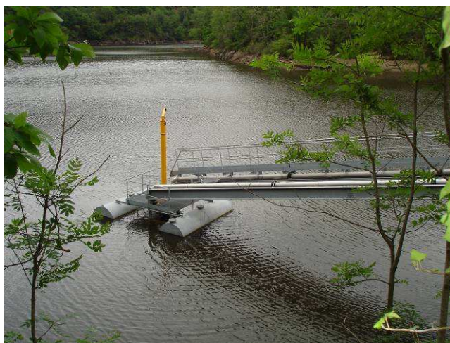
Figure 24. Mât oscillant en phase de mise en place au Bec d'Ambes en Gironde
