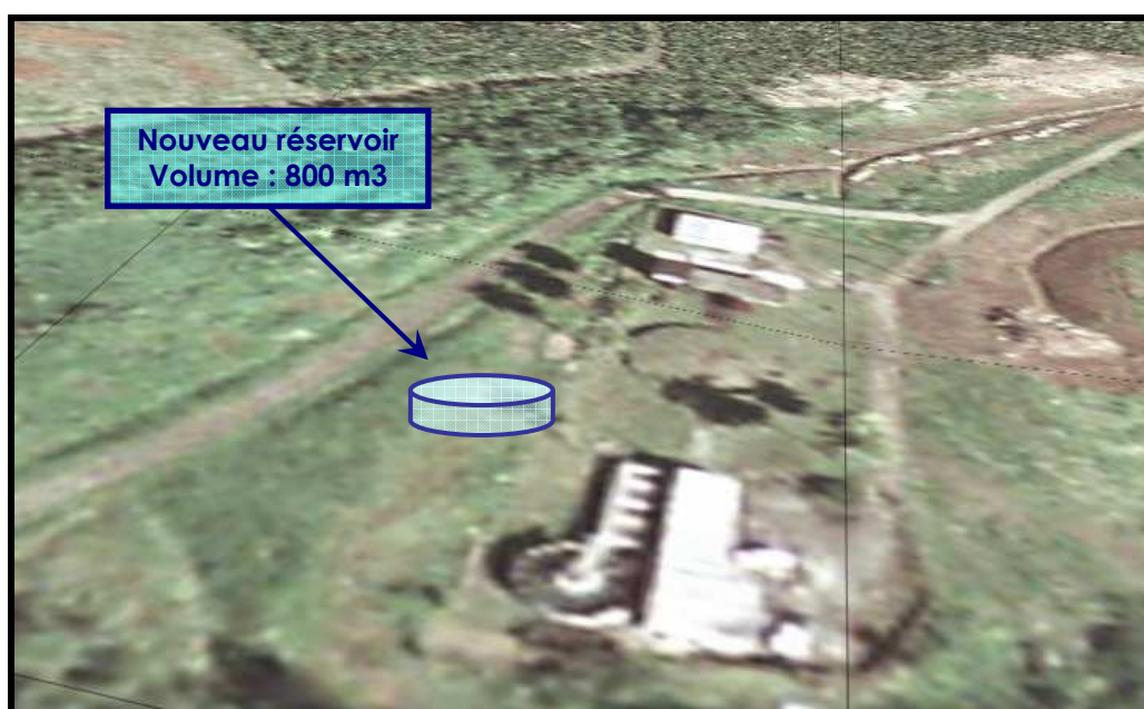
Figure 18 : Stock. 2 – Emplacement potentiel du réservoir du Lorrain
