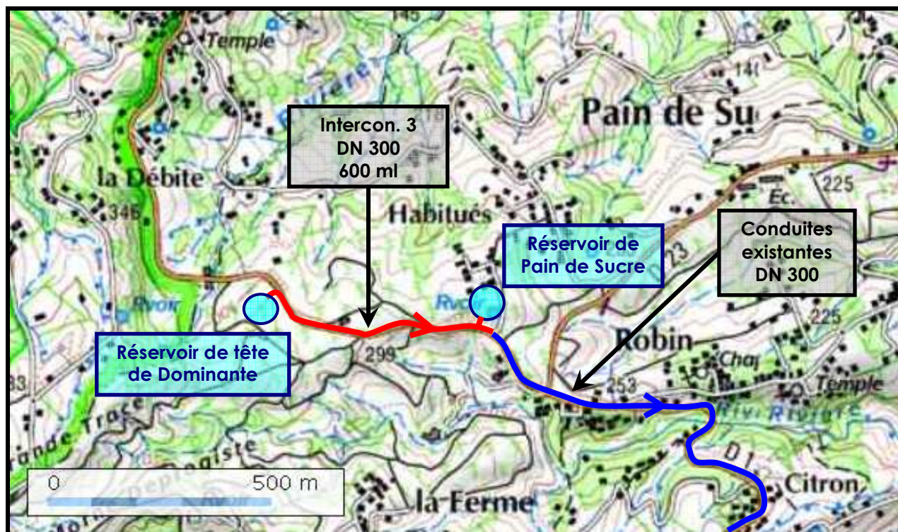
Figure 22 : Intercon. 3 – Tracé de la conduite d'adduction
