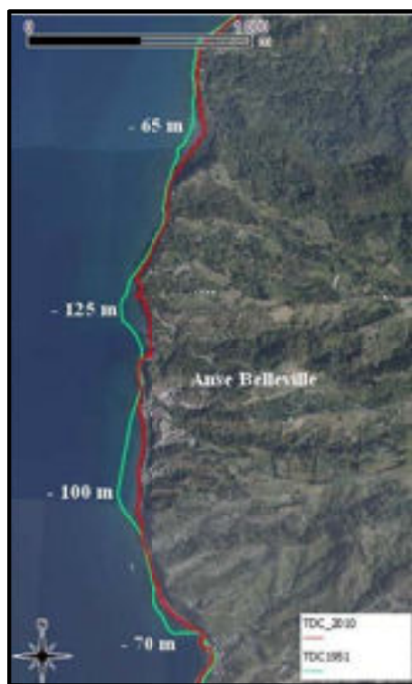
Illustration 29 : Recul du trait de côte de 1951 à 2010 au niveau de l'Anse Belleville (Prêcheur). Fond cartographique : Ortho HR 2010 - IGN (1/12000)
