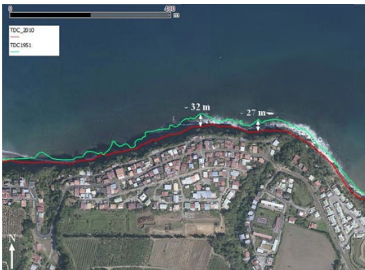
Illustration 30 : Erosion des falaises de Macouba. Fond cartographique : Ortho HR 2010 - IGN (1/5000)
