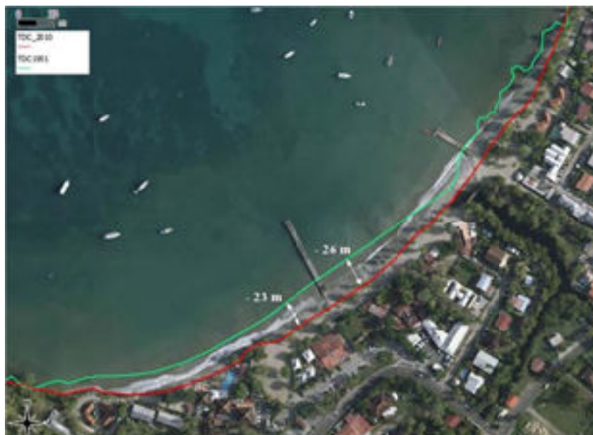
Illustration 31 : Recul du trait de côte au niveau de la plage de l'Anse à l'âne aux Trois Ilets Fond cartographique : Ortho HR 2010 – IGN (1/2500)
