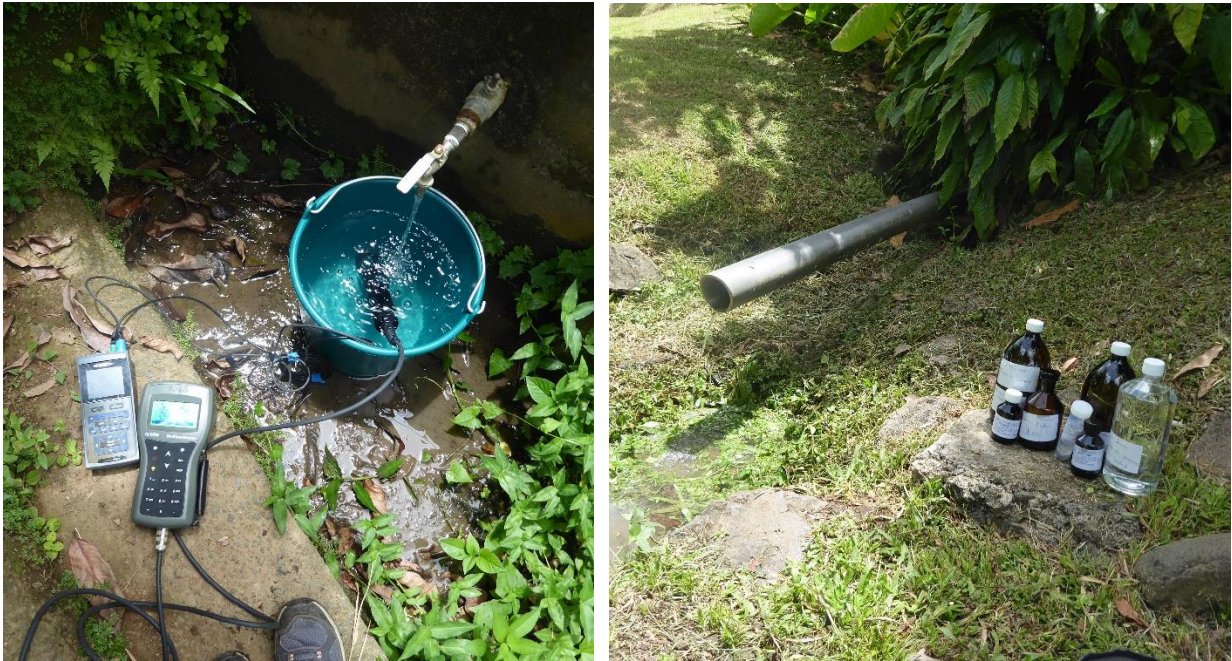
Illustration 3 : Mesures des paramètres physico-chimiques in situ à la source La Jacques (à gauche) et prélèvements d'eau à la source Bodard (à droite)
