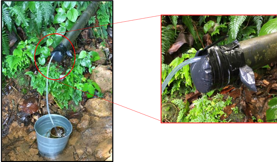
Illustration 5 : Prélèvement de gaz dissous CFC et SF 6 à la source Cimetière. Dispositif mis en place pour éviter la contamination d'origine atmosphérique
