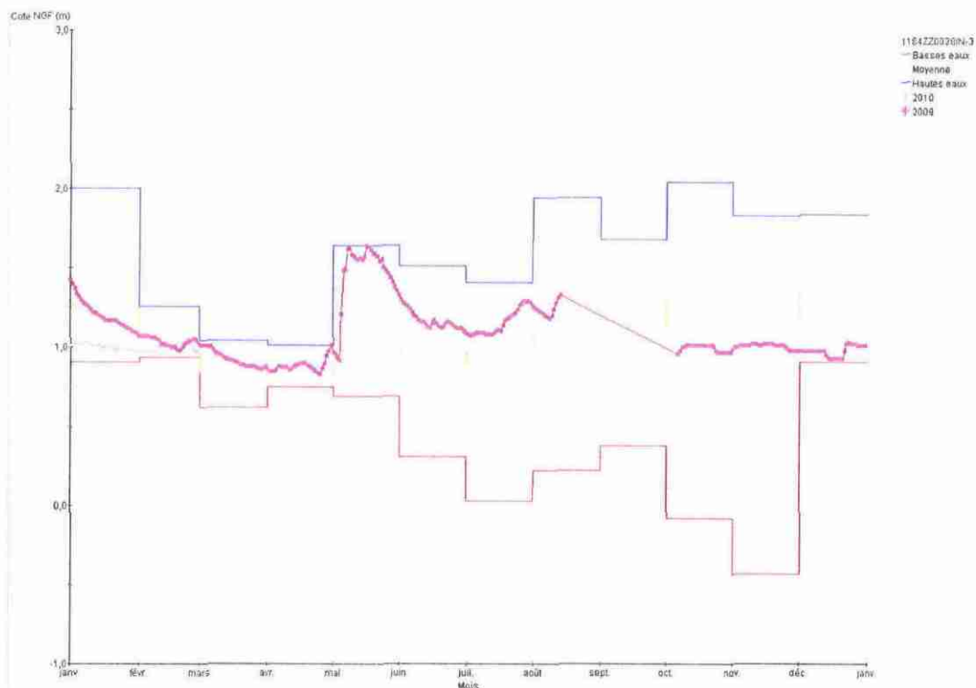
Piézomètre du DIAMANT – Puits Dizac (Mesures bimestrielles de 1993 à 1994 et de 2003 à 2005, journalières depuis janvier 2005)
