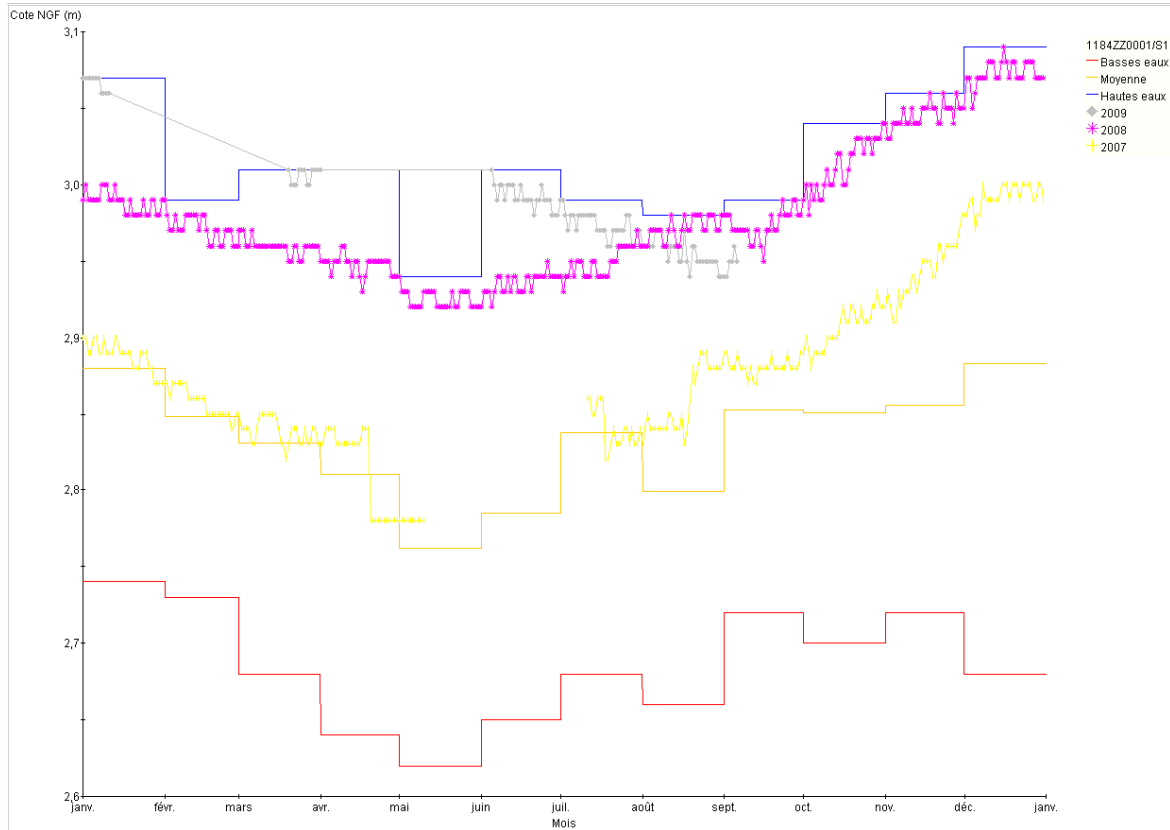
Piézomètre du DIAMANT – forage Dizac (Mesures mensuelles de 1992 à 2004 puis journalières depuis janvier 2005)
