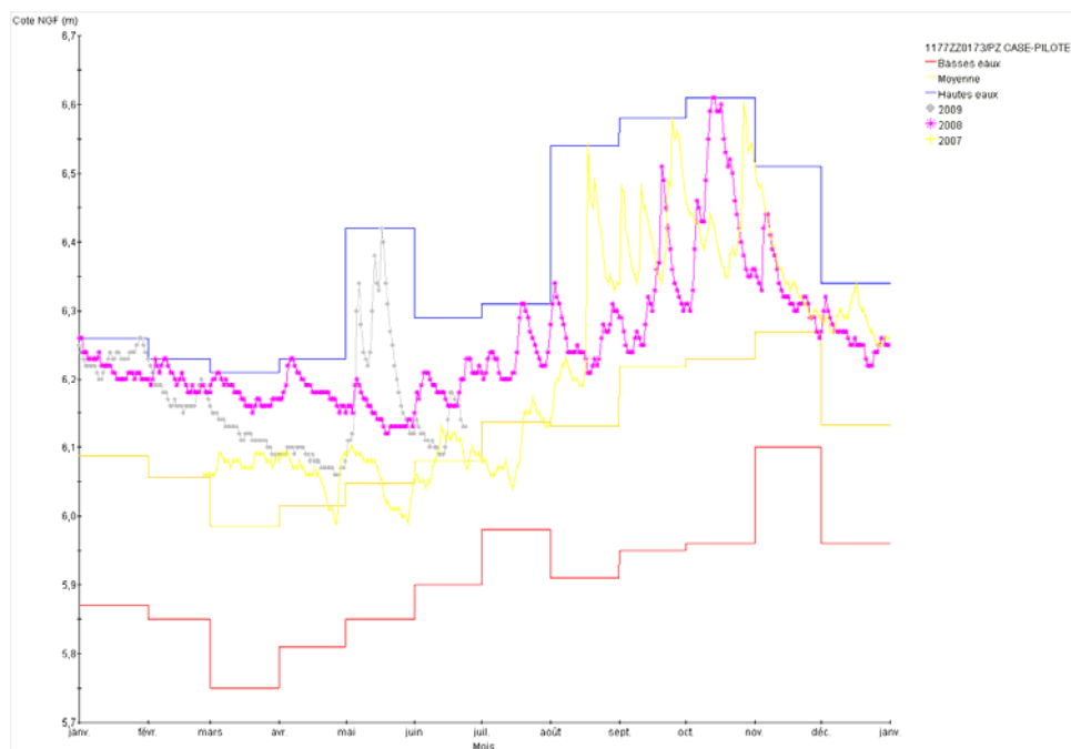
Piézomètre de CASE PILOTE – Maniba (Mesures journalières depuis janvier 2005)
