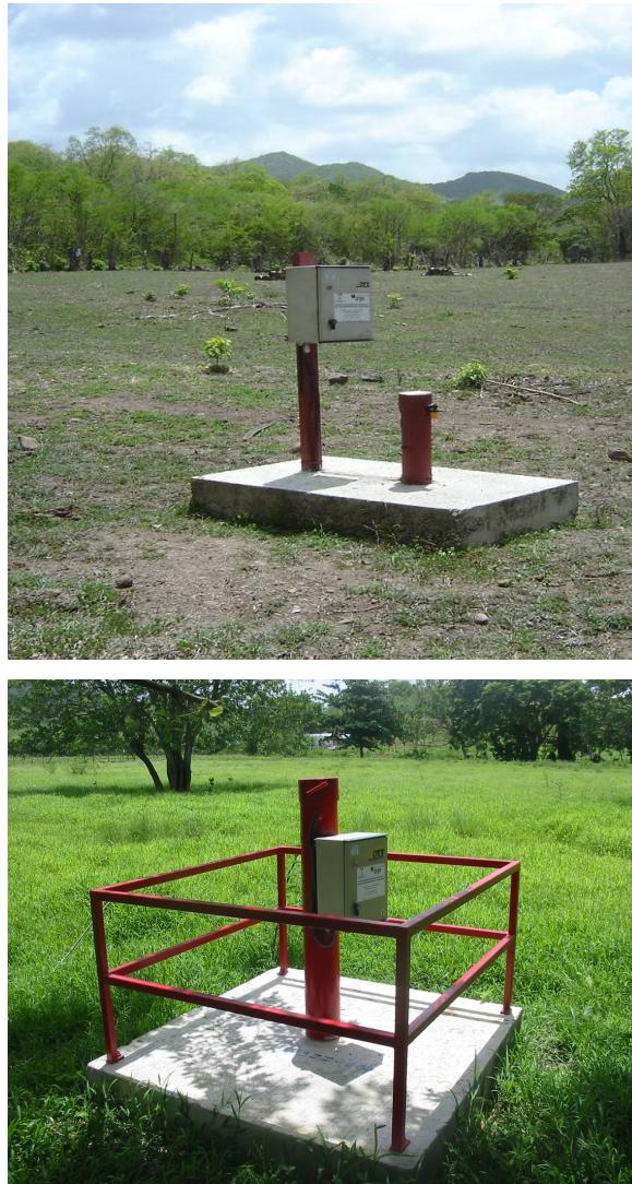
*Illustration 5 : vues de piézomètres du réseau régional équipés de dispositifs de télétransmission intégrés*
