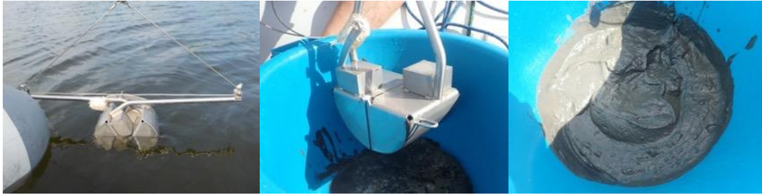
Figure 8. Prélèvement d'un échantillon composite de sédiments, homogénéisation et mise en flacon (21/11/2023)
