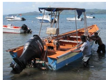
Yole de pêche " TIP TOP " de 7,2 m motorisée (150cv) et équipée d'une table traçante et d'un treuil
