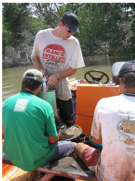
Tamisage « doux » du sédiment sur tamis de 1mm
