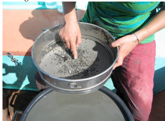
Tamisage « doux » du sédiment sur tamis de 1mm
