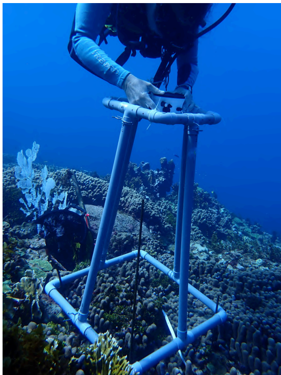
Figure 5. Structure mise en place pour améliorer le suivi des photo-quadrats
