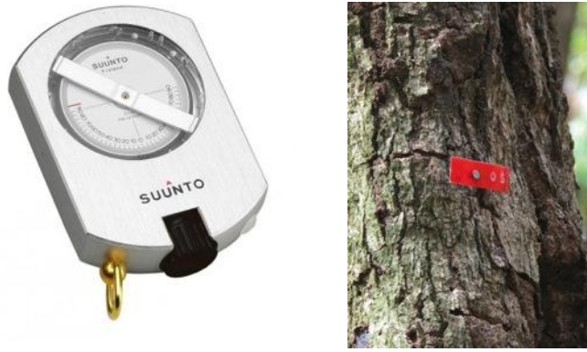
Figure 29 : Clinomètre Suunto : mesure de la hauteur des arbres (A), étiquette DYMO : identification des arbres (B), (Impact Mer)
