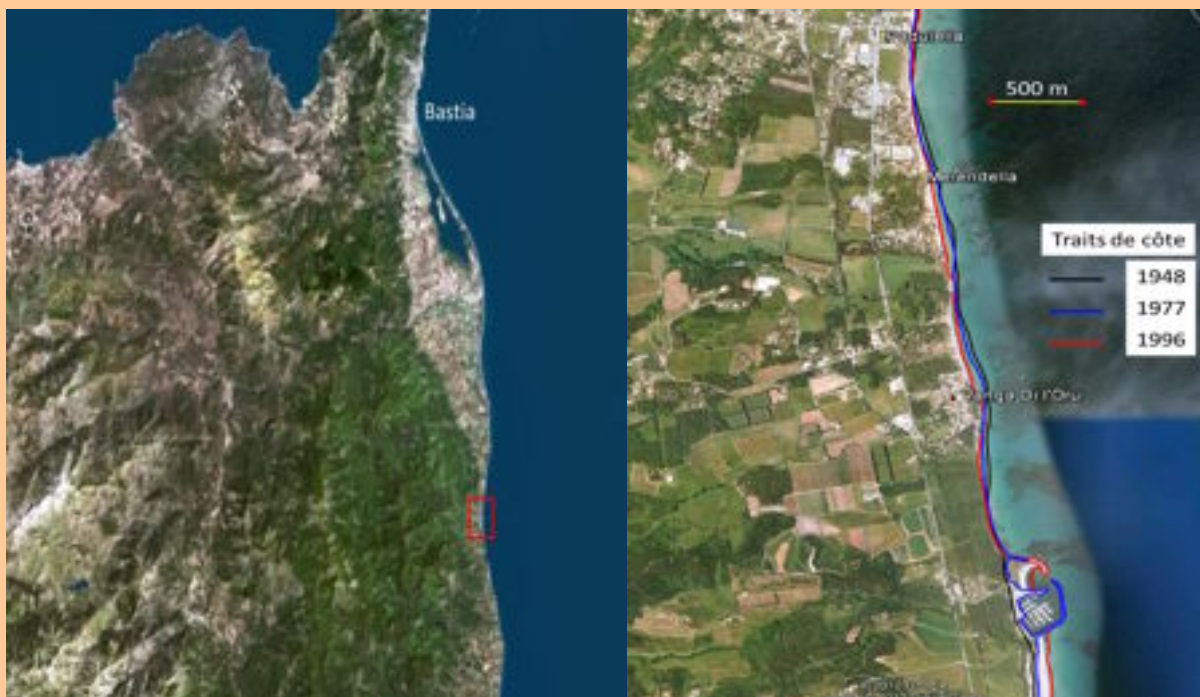
Illustration 15 : Traits de côte en 1948, 1977 et 1996 au nord du Port de Taverna. Fond cartographique Google Earth – Orthophotographie IGN 2007.
