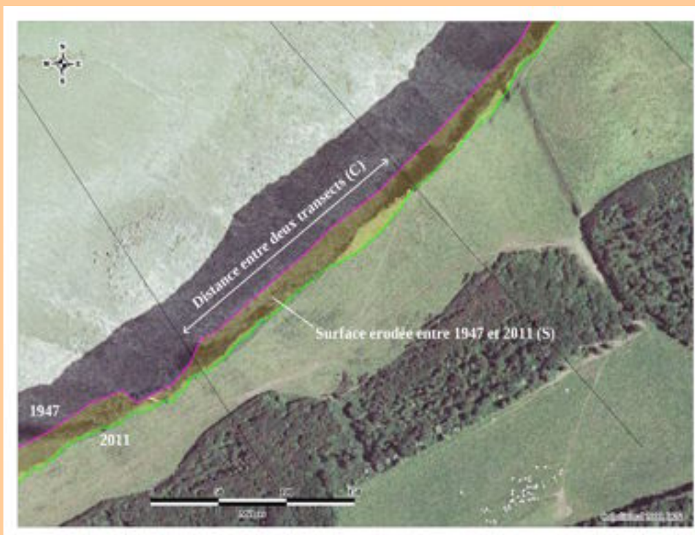
Illustration 25 : Exemple de découpage de la côte et bilan surfacique du recul entre 1947 et 2011 (Source : Ortholittorale 2000 et CETE Nord-Picardie)
