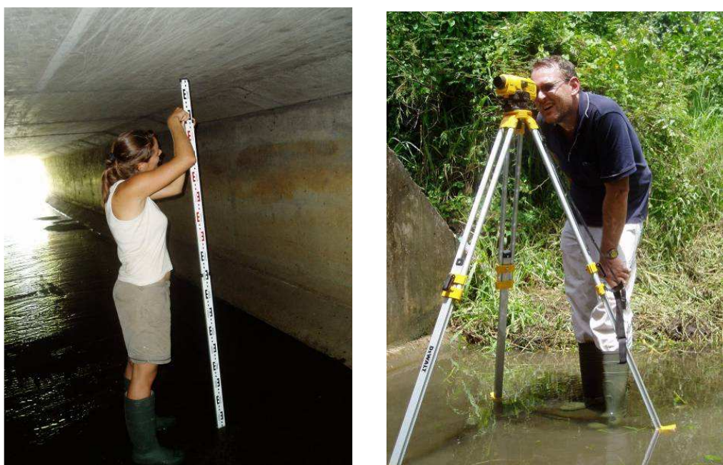
Figure 29 : Illustrations de la mesure de la pente du canal au théodolithe
