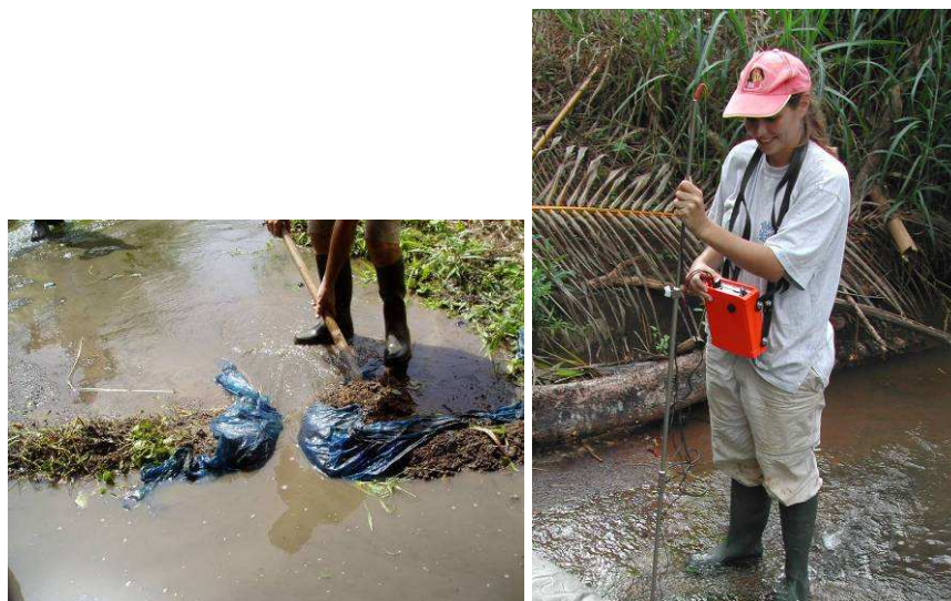
Figure 24 : Illustrations du jaugeage en étiage (canalisation du flux et mesure)
