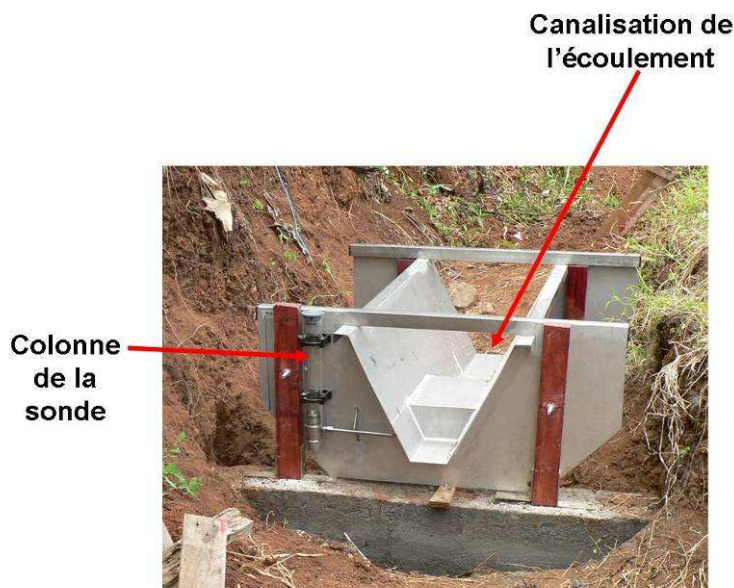
Figure 1 : Canal venturi installé en ravine
