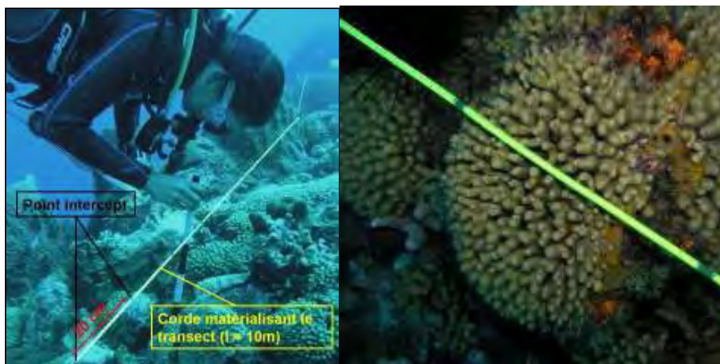
Photo 9 . Transect de 10m matérialisé par une corde marquée au feutre tous les 20 cm et tendue sur le fond (© OMMM).
