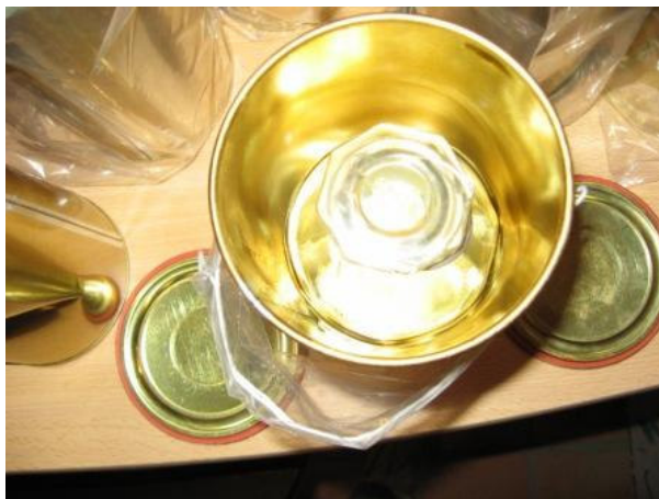
Illustration 4 : Système de prélèvement utilisé pour les CFC et SF6
