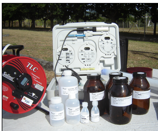
Photo 1 : Matériel et flacons utilisés lors des prélèvements (de gauche à droite : sonde piézométrique indiquant en plus la conductivité de l'eau et sa température, flacons en polyéthylène et en verre ambré, malette d'analyses physico-chimiques in situ , échantillonneur en polyéthylène).
