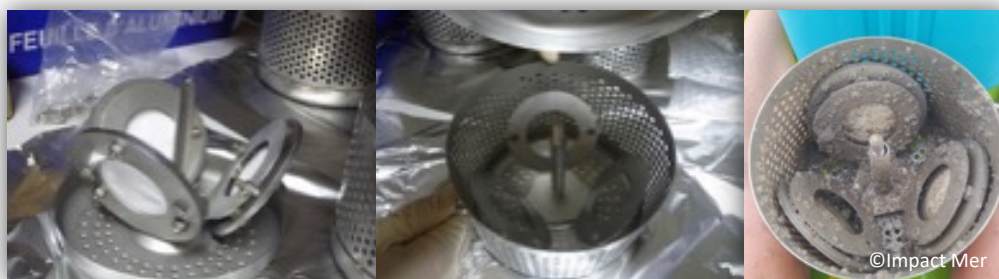
Figure 3. Conditionnement et déploiement de POCIS en triplicat
