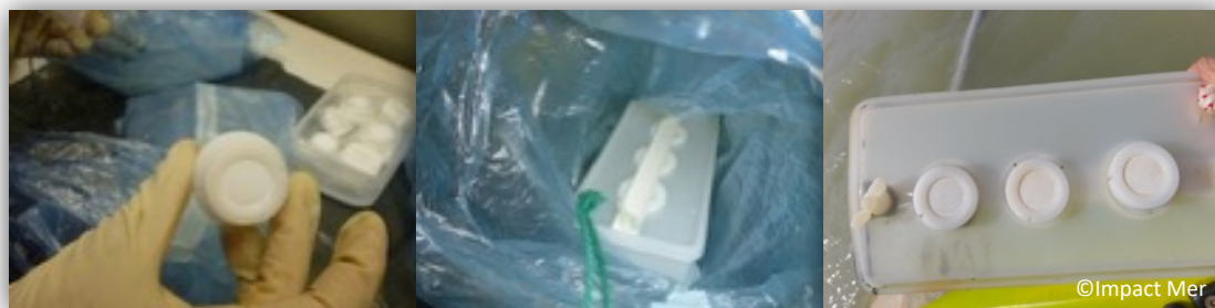
Figure 2. Conditionnement et déploiement de DGT en triplicat
