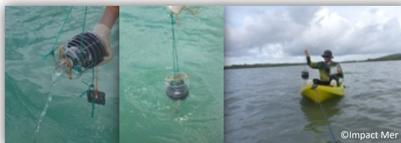
Figure 4. Prélèvements d'eau et extractions SBSE
