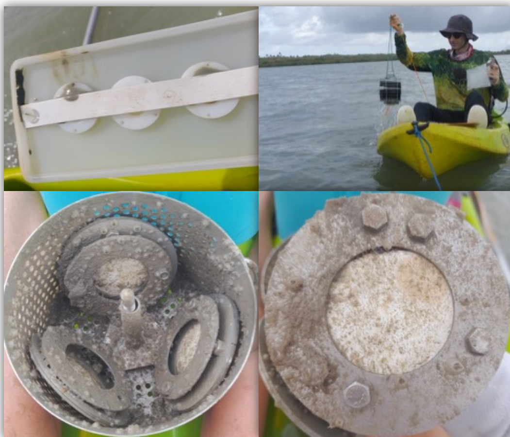
Figure 5. Aspect des DGT et POCIS à la relève, et prélèvement SBSE
