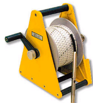
Sonde piézométrique et sonde multiparamètre utilisées par le BRGM pour les mesures de niveau, conductivité et température des eaux souterraines
