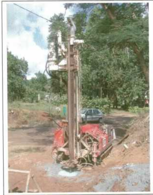
Photo 1 : Photo de la foreuse utilisée par l'entreprise SAFOR, forage à l'eau et au tricône. Site de Saint Joseph.
