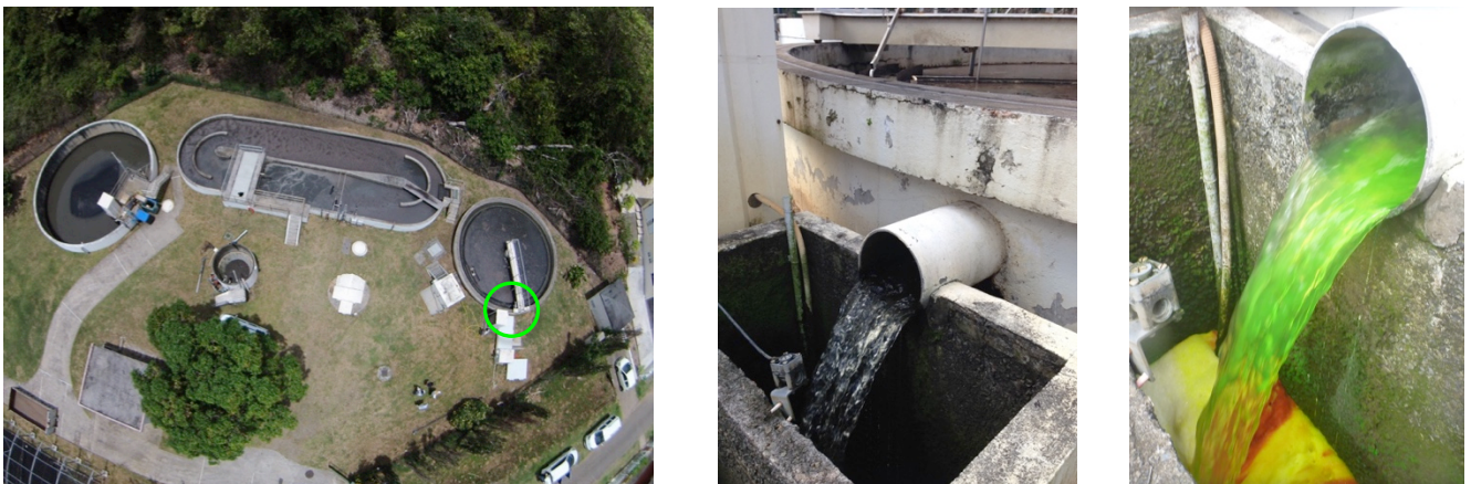
Figure 7 : Injection du colorant au niveau de la STEU de Tartane (1) Localisation du point d'injection du colorant - (2) Point d'injection - (3) Injection de colorant
