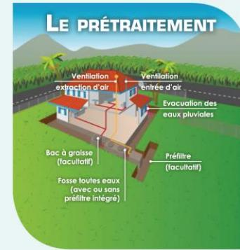
L'ensemble est obligatoirement équipé d'une double ventilation (fiche n°2) permettant la circulation de l'air de l'amont à l'aval du passage des eaux dans les autres dispositifs de prétraitement.
